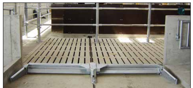
▲ PKSF zur Räumung auf Teilflächen mit Spaltenböden
