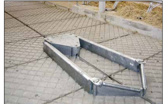
▲ Faltbreitschieber im Rücklauf
