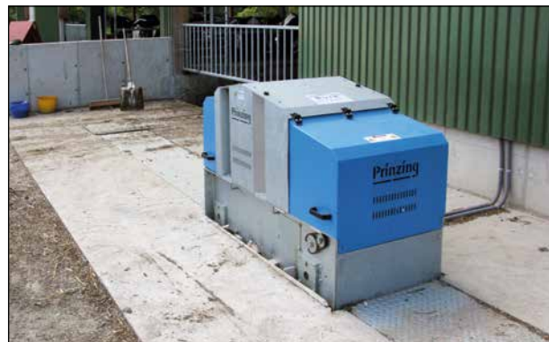
▲ Doppelantriebswinde DW7 mit Seilführung in einem abgedeckten Bodenkanal.
