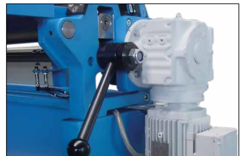
Motorische Positionierung der Hinterwalze
